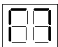
После программирования индикация конечного положения ОТКР
